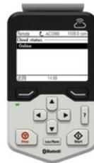
Das ABB Drive Connectivity Panel nutzt aktuellste Mobilfunk-Technologien für das Internet der Dinge, um Frequenzumrichter aus verschiedensten industriellen Umgebungen zu digitalisieren und an die Cloud anzubinden.
