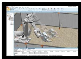
RobotStudio wurde um eine Funktion für die exakte Simulation des realen Bremswegs von Robotern erweitert, die das Einplanen von Sicherheitszuschlägen in Zellendesigns überflüssig macht.
