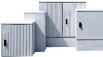
Speziell für den Außenbereich wurden die Kabelverteilerschränke der Reihe EH entwickelt. Alle Schränke werden aus glasfaserverstärktem, selbstverlöschendem und halogenfreiem Polyester hergestellt und bieten Schutzart bis IP44.
