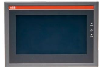
Das Human-Machine-Interface für Schaltschränke, überwacht und steuert bis zu 28 elektrische Geräte gleichzeitig. Lite Panel ist in das Vor-Ort-Kommunikationsnetzwerk eingebunden und zeigt Daten als Digital Twins über vordefinierte Templates.
