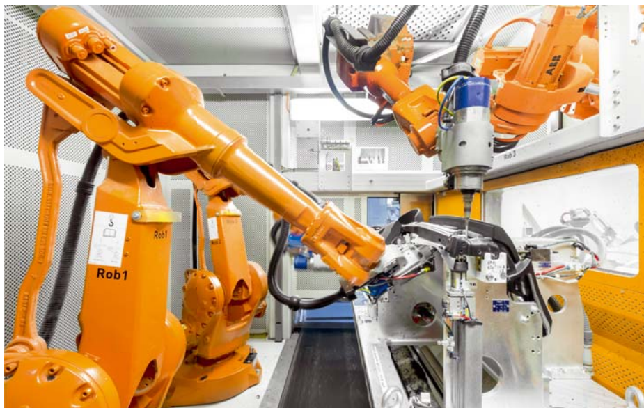
In der Fräszelle bearbeiten drei Roboter das Bauteil simultan.
